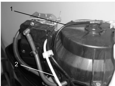
1. Cavo di protezione dell'ingranaggio di avviamento 2. Cavo dello starter
