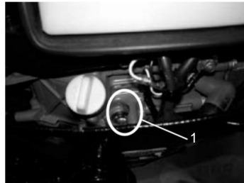
1. Finestra di controllo del livello dell'olio
